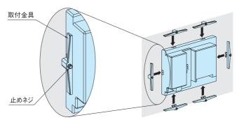
③コントロールモニターに取付金具(6ケ所)を差し込み、止めネジで固定して完了です。
