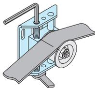
ベルトを掛けて調整ボルトでテンションを張り、下部六角ナットで固定します。
