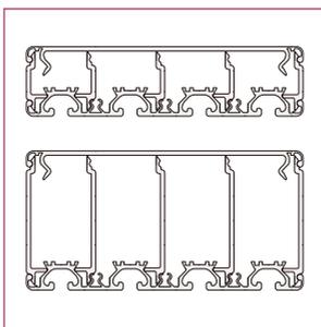
コンジットを組むときの側壁面にご使用ください。コンジット内部の仕切りにも利用できます。
