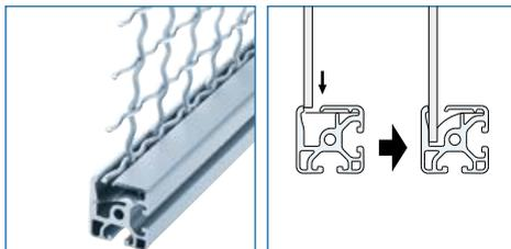
クランププロファイルにクランププロファイルエコノミー-BNを挟む事でパネル類が溝から抜けるのを防ぎます。
