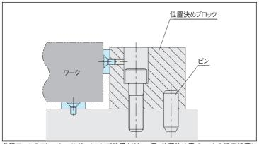
各種ワークのストッパー、サポーターにご使用ください。又、位置決め用ブロックの精度補正は レストボタンを再研磨することによって容易にできます。
