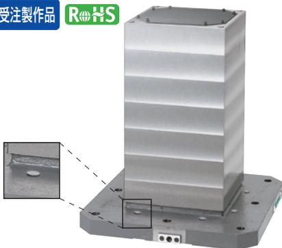
**⚠** 使用面は、片肉0.5mmのセルフカットを残した状態で直角度、平行度、面粗度が仕上げられています。ワークの加工精度に合わせてこのままご使用していただくことも使用機械でセルフカットしてご使用していただくこともできます。
