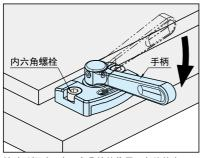
转动手柄后,夹口在凸轮的作用下向外伸出,
