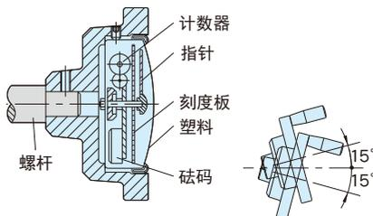
安装角度可与水平面成15°夹角(最大)。
