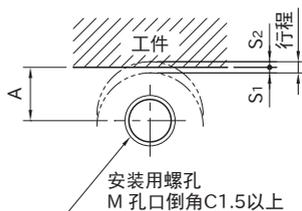
※ A尺寸为工件端面至螺孔的推荐尺寸。
