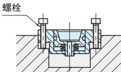
拆卸圆锥套产生困难时, 请将螺栓拧入拆卸用螺孔, 旋拧, 完成拆卸。
