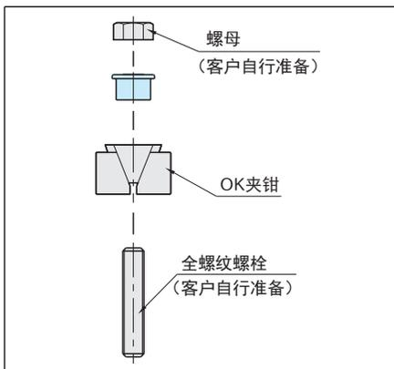
把全螺纹螺栓固定在金属板的螺丝孔里面后，按照OK夹钳、全螺纹螺栓用套、螺母的顺序安装。然后，用扳手等旋转螺母，进行夹紧/松开的操作。
