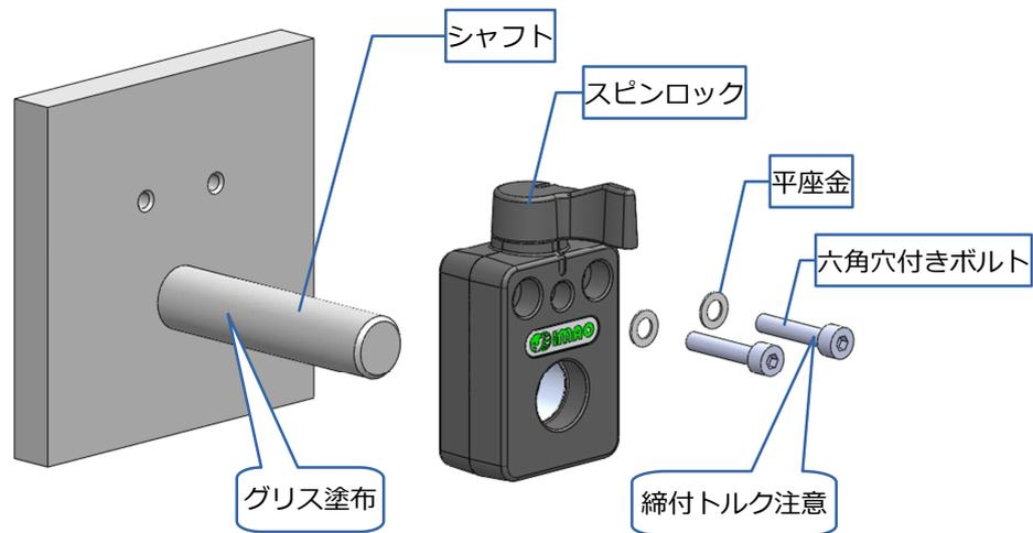
1. 取付け時のキズ等による不具合を防止するため、シャフトのバリやゴミを除去し、シャフトとスピンロックの摺動面にグリスを薄く塗布してください。
