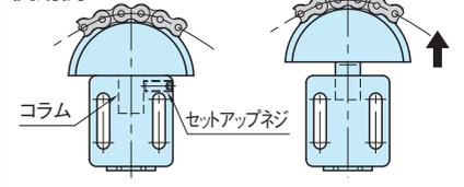
コラムを本体内部にいれ、セットアップネジを締付けてください。セットアップネジを緩めると、スプリングが作動しチェーンにテンションがかかります。
