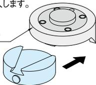
2. リングを矢印方向に止まるまで回転させ固定します。
