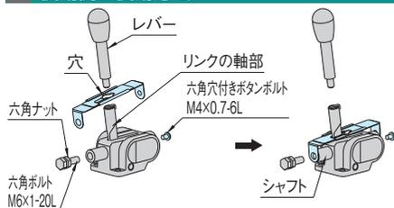
レバーを取外してから、上図のようにスライドプレートの2枚のプレートの穴を揃え、リンクの軸部を通して組付けてください。
