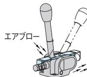
レバー操作に従ってスライドプレートが可動し、本体上面の溝を塞ぎます。(注:細かい粉塵などは、上面の溝の隙間からエアブローして下面から吹き飛ばしてください。)
