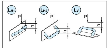
6.7Nの硬球の落下試験に基づき、破壊点の平均値を記載してあります。L (J) = P (N) × h (m)
