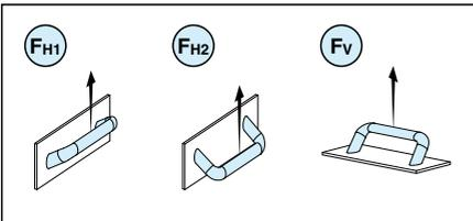
F<sub>H1</sub>, F<sub>H2</sub>とF<sub>V</sub>は通常の作業条件で重量物を持ち上げる場合の破壊点の平均値です。
