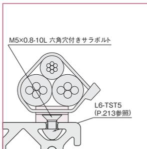
Line6プロファイル T溝への取付。
