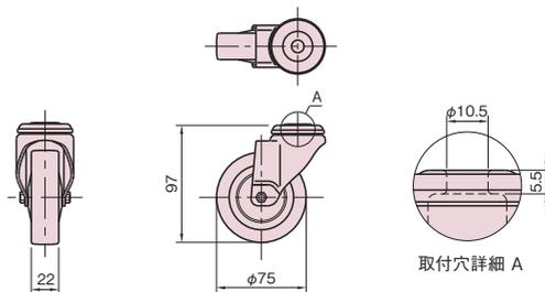
**!** レンチがローラに干渉する為、ローラを取外してボルトをお取付ください。
