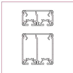
コンジットを組むときの側壁面にご使用ください。
