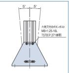
平らでない床面に設置する場合、長穴にて±5° の範囲で角度調整できます。
