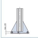
高さ調整をする場合は、プロファイル端面に六角 ボルトを付けて行ってください。
