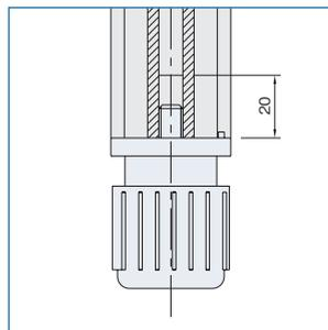
フレーム端の取付穴(M8×1.25)は深サ 20mmでタップ加工してください。
