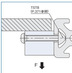
本体はTナットSTなどを使用してプロファイルへ固定してください。
