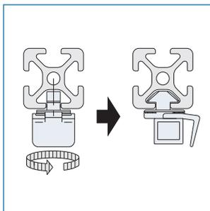
T溝にセットし、捻るだけで固定できます。
