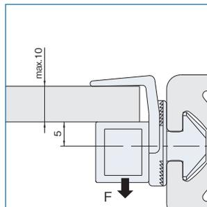
パネルやボードを穴加工やネジ締めなしでプロファイルに取付でき、スライド部のロックはスクリュードライバーで緩みます。
