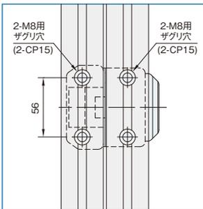
SPH4040Nに取付ける場合のプロファイル加工寸法。
