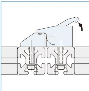
ドアロックの上部を引上げることによって、掛け金が内部へひっこみます。
