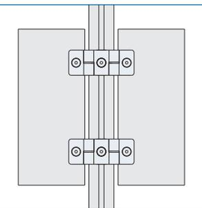
HLD6032R,Lの組合わせ、又はDHL10032の取付向きを上下反対にする事によりドアの抜け防止ができます。
