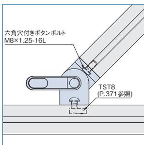
プロファイル端面に取付る場合は、M8×1.25 深さ20mm(加工品番 M8×20)のタップ穴加工をしてください。又、付属のロケーターはT溝取付の位置決めに有効です。
