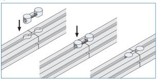
③ 組付位置を確認してドライバータイプのボールレンチにて締付けてください。 最後にL型レンチにて増し締めを行いましたら接続は完了です。
