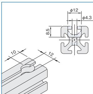
Line5 プロファイルのジョイント取付部は、φ12ザグリ深サ8.5mm φ4.3下穴(加工品番 U12)の加工をしてください。
