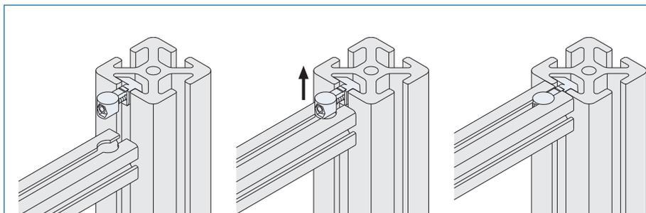
③ 組付位置を確認してドライバータイプのボールレンチにて締付けてください。最後にL型レンチにて増し締めを行いましたら接続は完了です。
