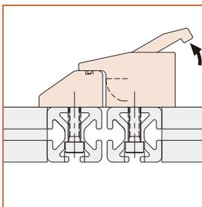
ドアロックの上部を引上げることによって、掛け金が内部へひっこみず。
