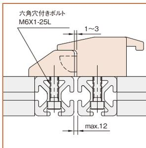
L6-SPH3030Nに取付ける場合のプロファイル加工寸法。 取付詳細。
