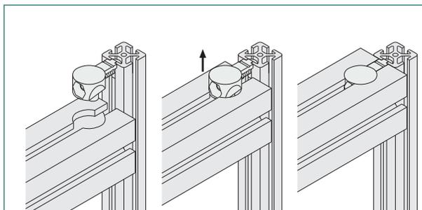
③ 組付位置を確認してドライバータイプのボールレンチにて締付けてください。最後にL型レンチにて増し締めを行いましたら接続は完了です。
