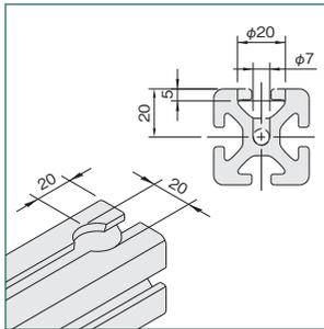
Line8プロファイルのジョイント取付部は、φ20ザグリ深サ5mm φ7深サ20(加工品番 P.U.J P.377参照)の加工をしてください。
