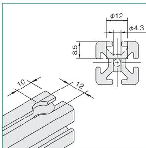
Line5プロファイルのジョイント取付部は、 $\phi 12$ ザグリ深サ8.5mm  $\phi 4.3$ 下穴(加工品番 U12)の加工をしてください。
