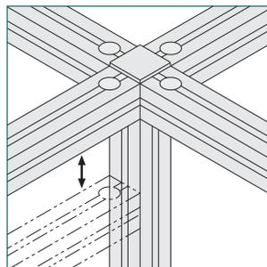
組付後でもボルトを緩めれば取付側プロファイルの溝上をシフトできますので、任意の位置に取付ける事ができます。
