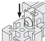
③ 再度、組付位置を確認してL型レンチにて締付けてください。
