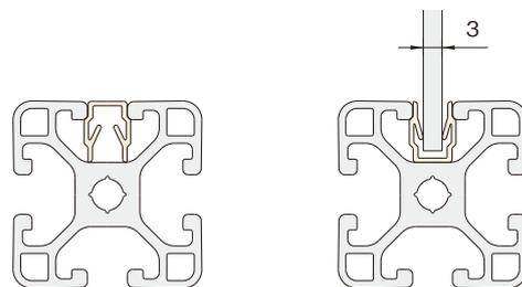
溝カバーのほか、溝へ厚さ3mmのパネルを挿入する場合の枠組みとしてご使用になれます。
