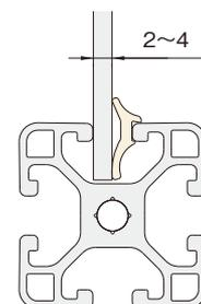
パネルを溝に隙間なく固定できます。
