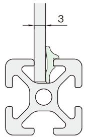
パネルを溝に隙間なく固定できます。
