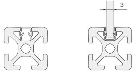
溝カバーのほか、溝へ厚さ3mmのパネルを挿入する場合の枠組みとしてご使用になれます。
