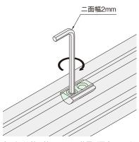
止めネジを締め付けることで、位置が固定できます。
