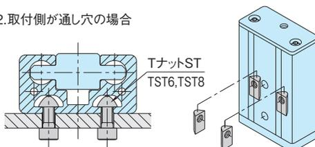
TナットSTを利用して固定します。 TナットSTは本体背面より挿入できます。
