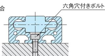
本体に設けられた通し穴を利用して六角穴付きボルトで固定します。
