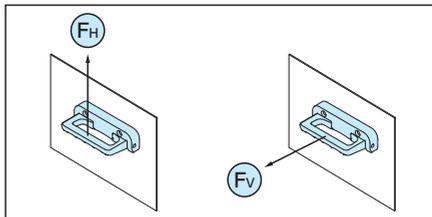
F<sub>H</sub>とF<sub>V</sub>は通常の作業条件で重量物を持ち上げる場合の破壊点の平均値です。
