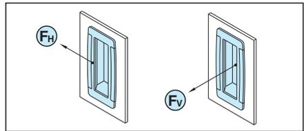
F<sub>H</sub>とF<sub>V</sub>は通常の作業条件下で重量物を持上げる場合の破壊点の平均値です。
