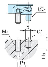
取付けにはクランプ時の本体の倒れ防止用の下穴(ピン用穴)が必要です。
