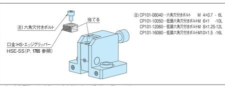
口金は交換可能です。交換は六角穴付きボルトを取外して行ってください。 取付けの際は、口金の背面をアームに当て組付けてください。
