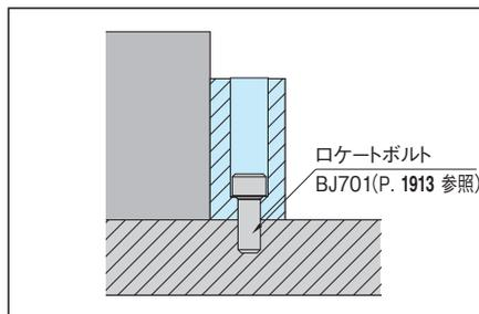
パーツの位置決めはロケットボルトをご利用頂ければ1本のボルトで位置決めと締付けができます。
