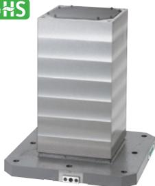
**!** 使用面は、片肉0.5mmのセルフカットを残した状態で直角度、平行度、面粗度が仕上げられています。ワークの加工精度に合わせこのままご使用していただくことも使用機械でセルフカットしてご使用していただくこともできます。
