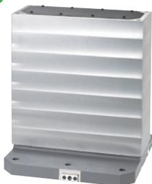
**!** 使用面は、片肉0.5mmのセルフカット代を残した状態で直角度、平行度、面粗度が仕上げられています。ワークの加工精度に合わせこのままご使用していただくことも使用機械でセルフカットしてご使用していただくこともできます。
