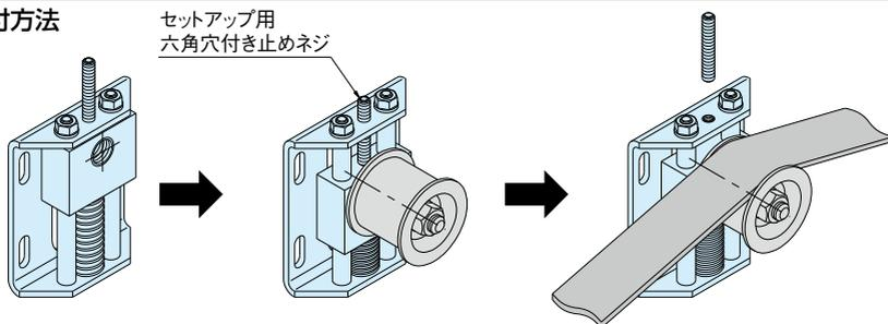
オートスライドタイトナーにアイドラーピンとプーリーアイドラーを取付けて、レンチにてセットアップ用六角穴付き止めネジを締込んでください。
