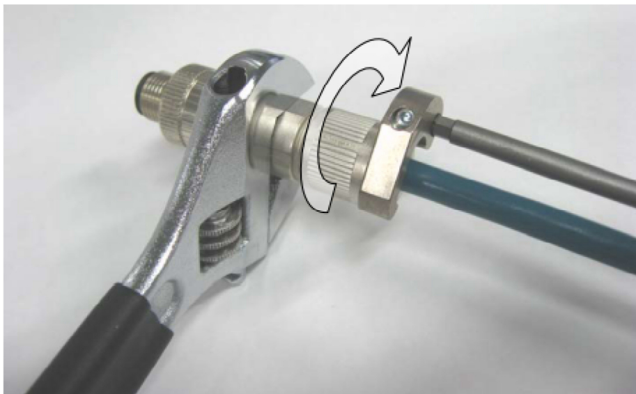
図 3-15 トルクドライバによるハウジングと締付けナットの締め付け
