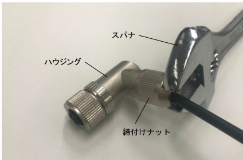
図 8. ハウジングと締付ナットの取付け
