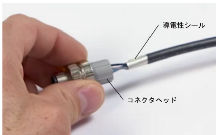
図 6. 導電性シールの貼付け
