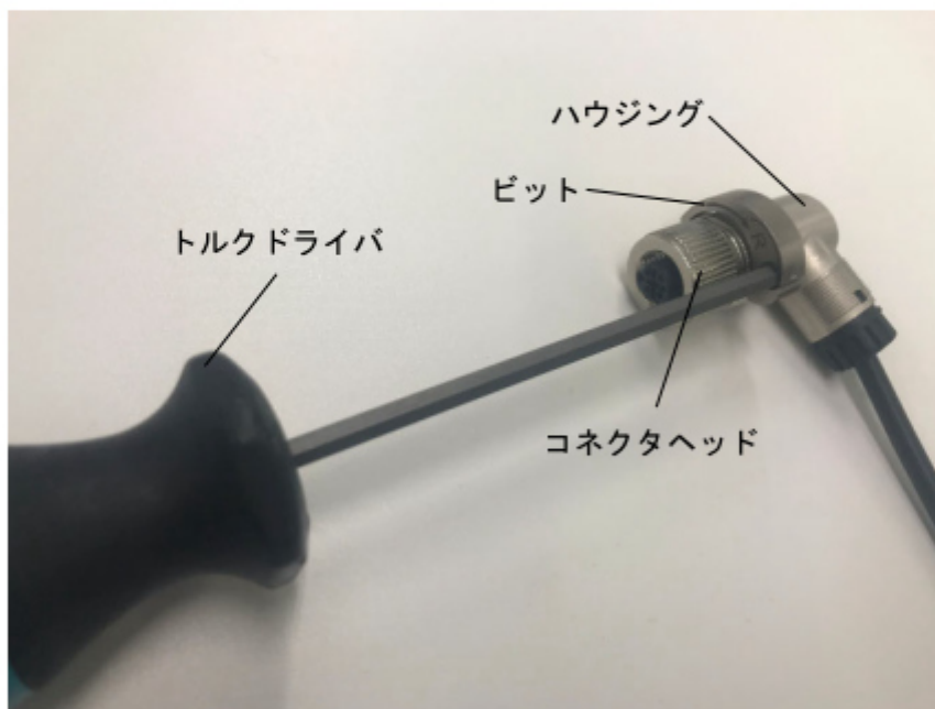
図 7. コネクタヘッドとハウジングの取付け
