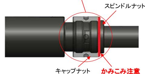
キャップナットを反時計回りに回し、
