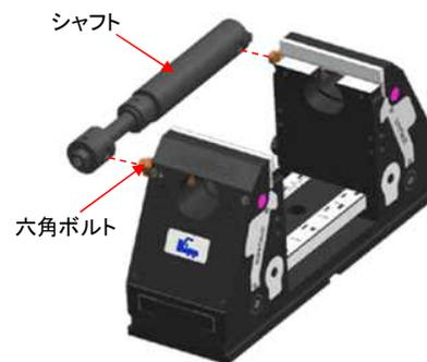
シャフトの穴が口金側面にある六角ボルトの位置に合うよう、長さを調整します。(組み立て前に、シャフト長さを調整するための工程です。)
