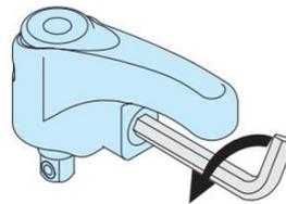
2. 調整用ネジを戻し、ねじ込み量を微調整します。
