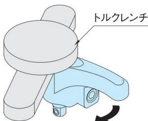
3. トルクレンチを使用してトルクを測定します。
