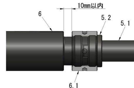
・キャップナット (6.1) を反時計回りに回し、スピンドルナット (5.2) に固定してください。
